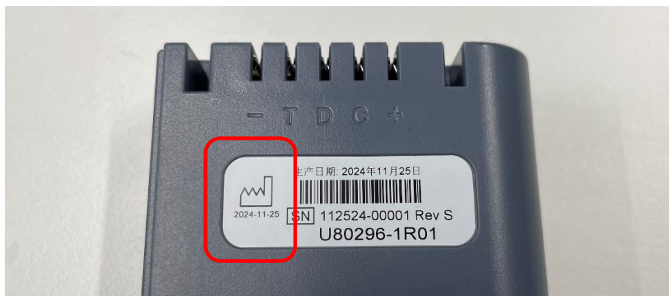
Figura 2. Exemplet de etichetă de pe bateria afectată. Conține codul de componentă „U80296-1R01”, revizuirea „Rev S”, data de fabricație „2024-11-25” situată sub simbolul pentru data de fabricație.
